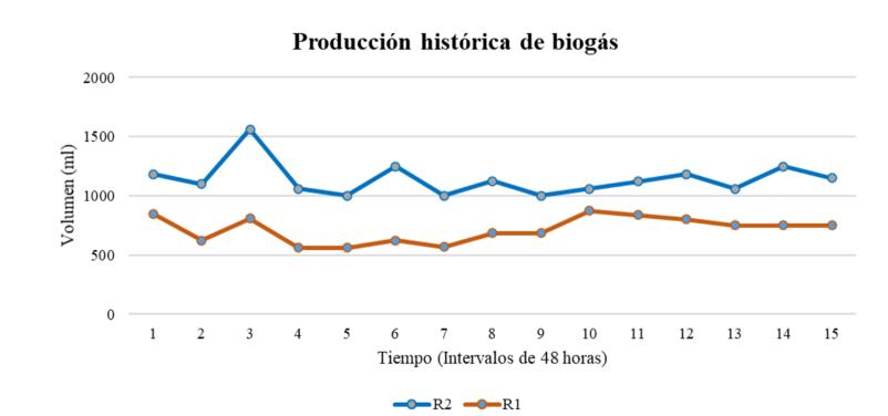
Se interpreta que existe una diferencia significativa (P < 0,05) en la producción de biogás entre los dos reactores, siendo el reactor 2 el que da mejores resultados de producción de biogás con base en su media. Quinchía et al. (2019) afirma que la variación de la temperatura afecta significativamente la digestión anaerobia y la cantidad de biogás producido. Bedoya y Chaparro (2016) manifiestan que la mayor producción de biogás está influenciada por el pH.
